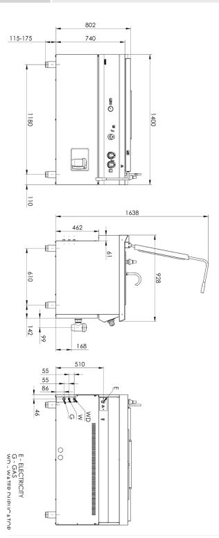
E - přívod napětí 400V WD - přívod vody do duplikátrou W - přívod vody
